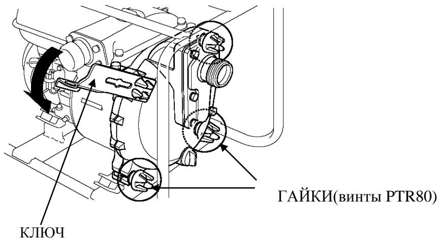
3. Снимите крышку насоса и выньте спиральную камеру из корпуса насоса. Очистите корпус насоса и спиральную камеру от возможной грязи.
